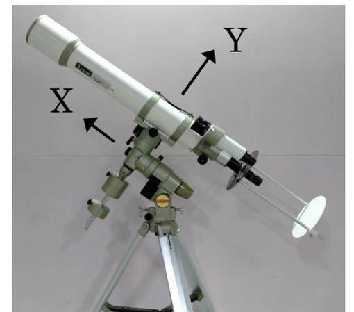
天体を観察する場合、赤道儀を使うと便利である。赤道儀は図のように鏡筒の下にあり、図中の  4 を北極星の方向に向けてモーターなどで一定の速さで動かすことで、天体を追尾することができる。
